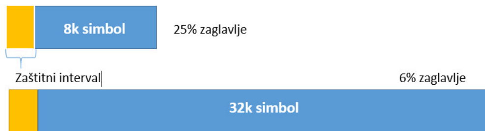
Slika 8 - Smanjivanje gubitaka povećavanjem FFT
